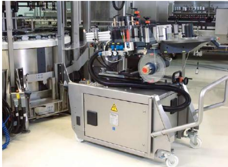
Figura 2.5: Cambio de una estación de Etiquetado en una Máquina Modular Fuente: http://www.krones.com
