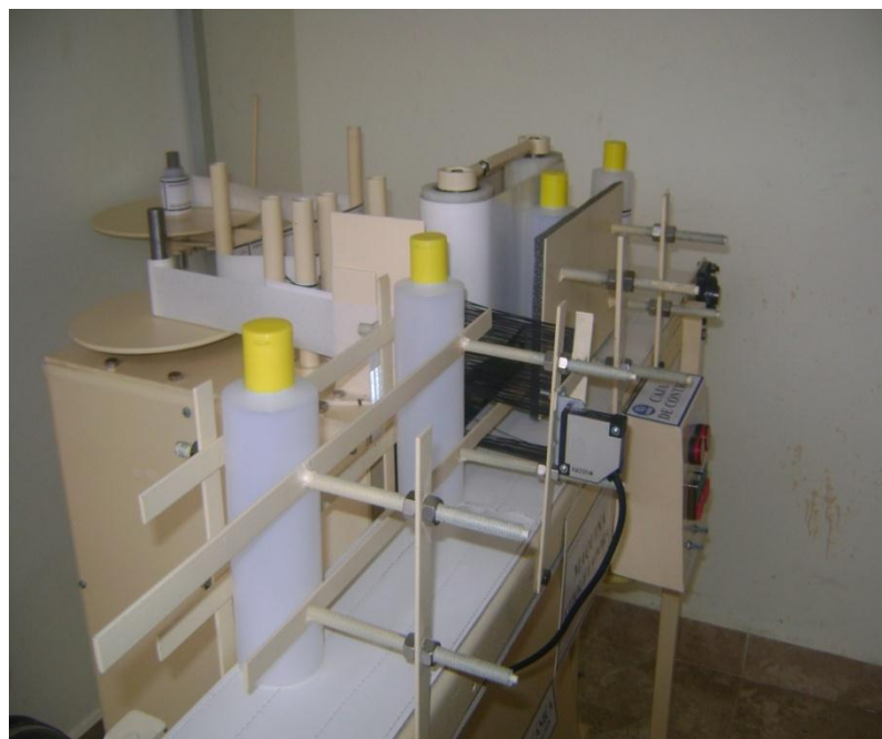
Figura 4.3: Ingreso de los Envases a la Máquina Etiquetadora Elaborado: Investigador (Criollo Fabián)
