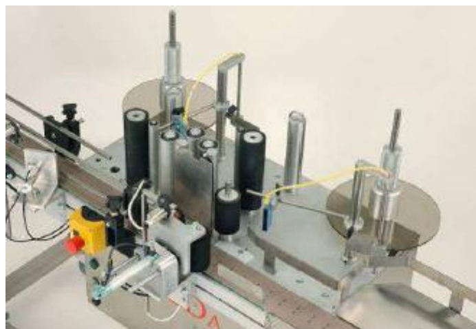
Figura 2.13: Cabezal de etiquetado de una etiquetadora lineal Fuente: http://www.cdafrance.com
