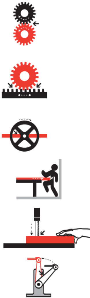
Gráfico N. 8: Riesgos de las partes móviles de la máquina
