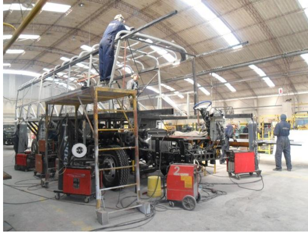
Foto N. 6: Área de Estructuras
