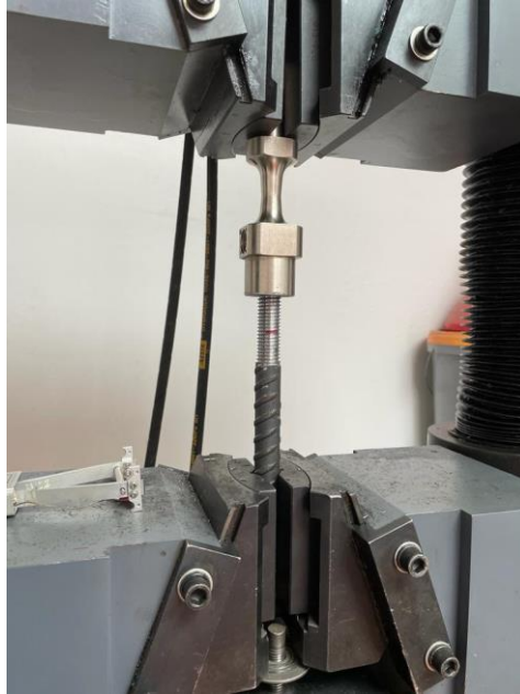
Ilustración 25. Ensayo de tracción en varilla de 5/8 in
