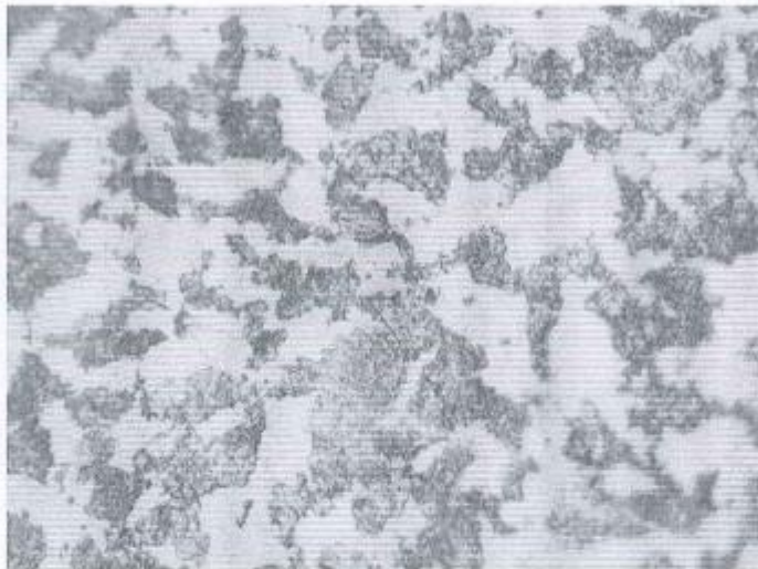
Figura 4. Microestructura magnificada a 1000X, NITAL al 4%, 50 seg.
