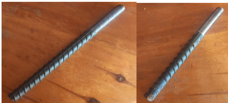
Ilustración 22. Roscado en varilla corrugada de acero ASTM A615
