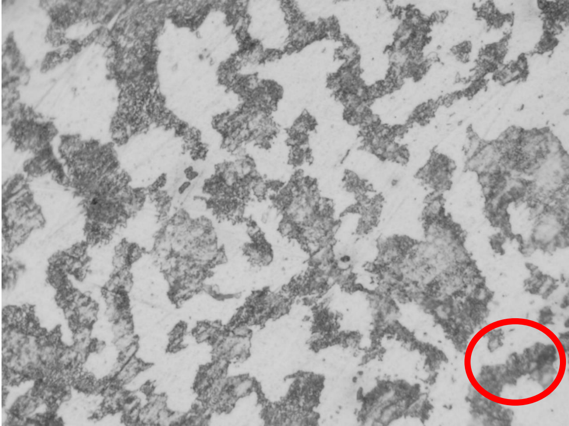
Ilustración 60. Incrustaciones de grafito en probeta de 5/8 in incremento de 1000x
