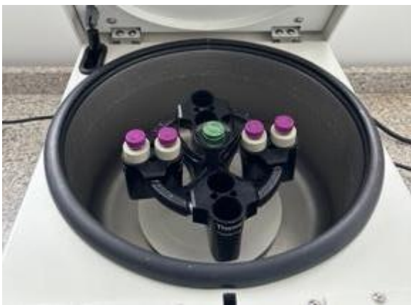
Anexo 23. Centrifugación de las muestras.
