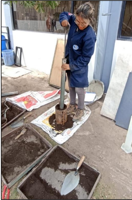
ANEXO 58: Compactación del suelo
