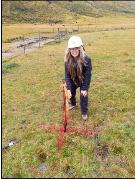
ANEXO 35: Colocación de punto de control
