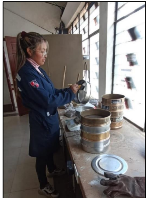
ANEXO 46: Pesaje del material tamizado
