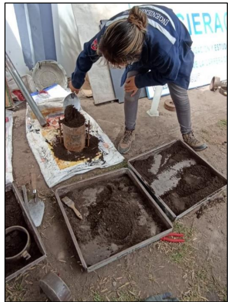
ANEXO 57: Colocación del suelo en el molde
