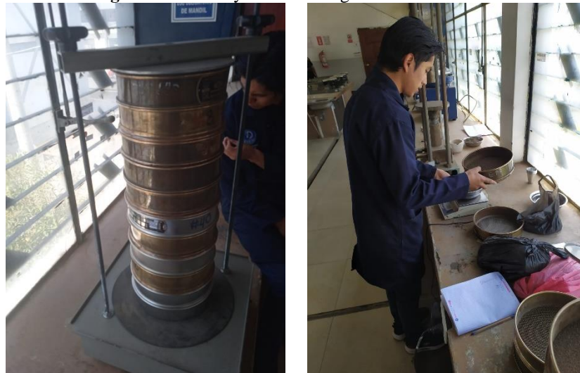
Imagen N° 06. Ensayo de análisis granulométrico
