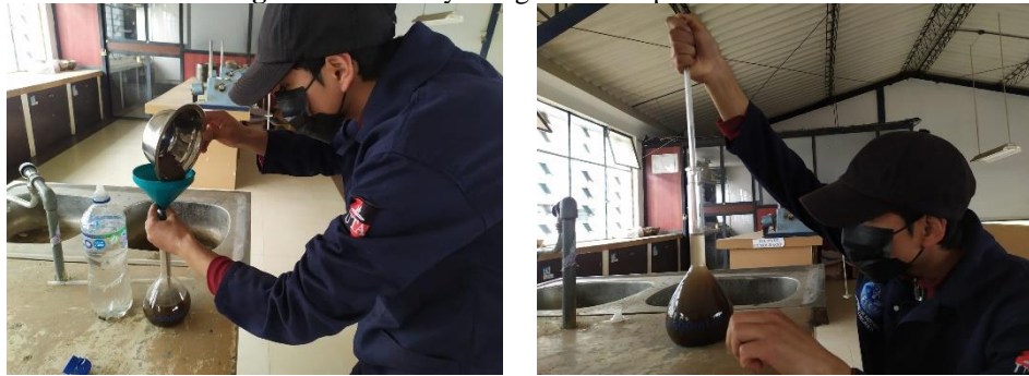
Imagen N° 07. Ensayo de gravedad específica
