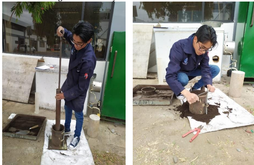
Imagen N° 10. Ensayo Proctor Modificado
