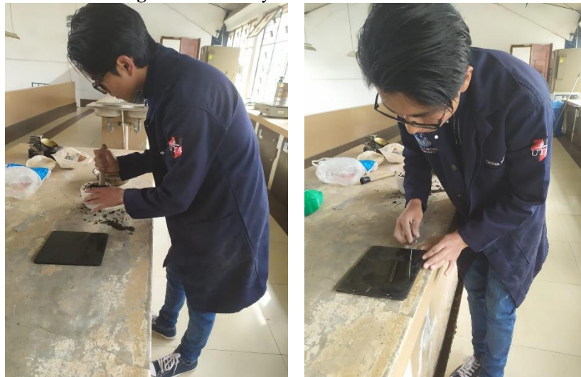
Imagen N° 09. Ensayo Límite Plástico LP
