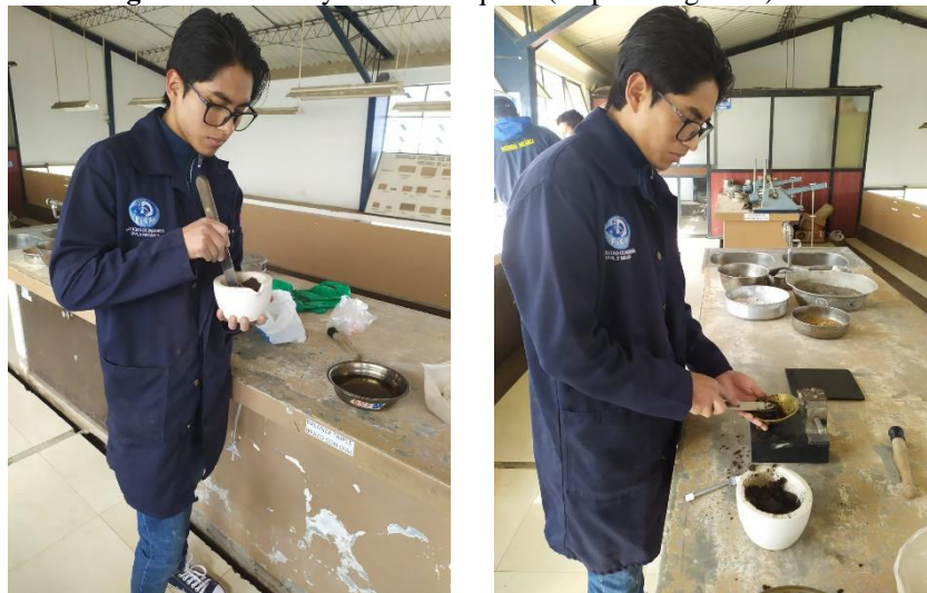
Imagen N° 08. Ensayo Límite Líquido (Copa Casagrande)
