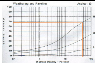
Abaco de Desprendimiento de Agregados
