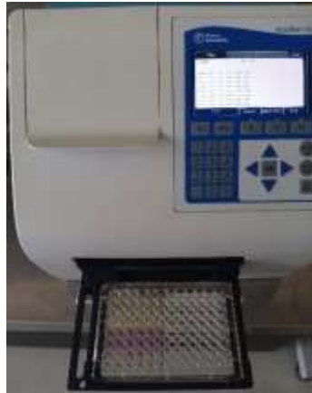
Figura 23. A: análisis de DPPH, lectura de placa en el espectrofotómetro
