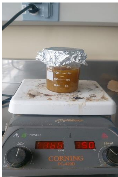
Figura 13.C: Extracción de los compuestos bioactivos utilizando Etanol al 80% durante 30 minutos a 50 °C.
