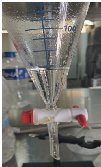
Figura 4. Separación líquido - líquido de aceite esencial
