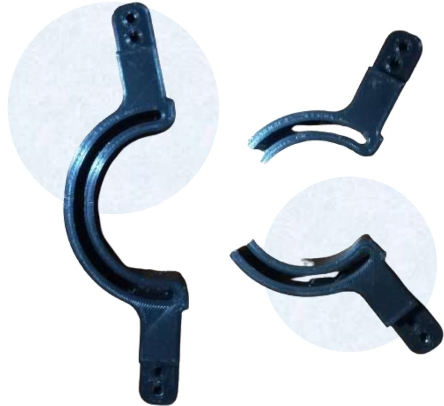
. La pieza impresa 1 con relleno del 10% al estar sometida a una fuerza externa se fragmentó por la mitad.
