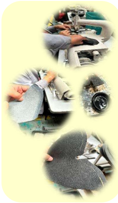
Ilustración 12 - Procedimiento de rayado y desbastado
