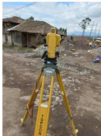
FIGURA 24 Levantamiento con estación total
