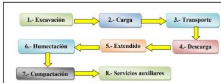
FIGURA 15. Diagrama De Funcionamiento De Movimiento De Tierras
