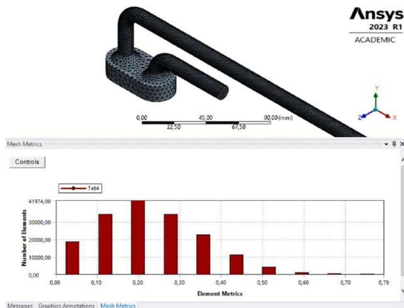
**Figura 13.** Calidad de los elementos de la malla para el análisis CDF
