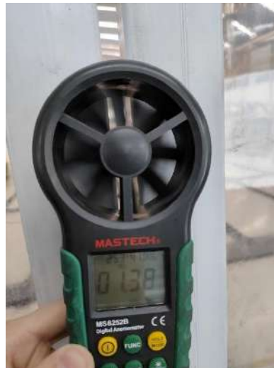
Figura 42. Velocidad del aire en el interior de la cabina medido con un anemómetro.
