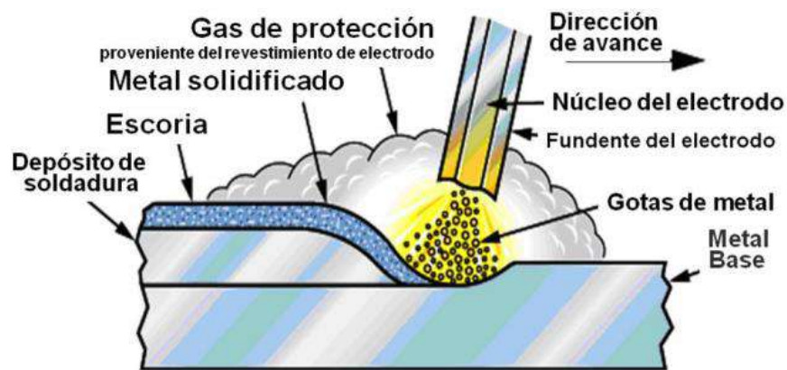
Figura 16. Diagrama esquemático del proceso de soldadura [23].
