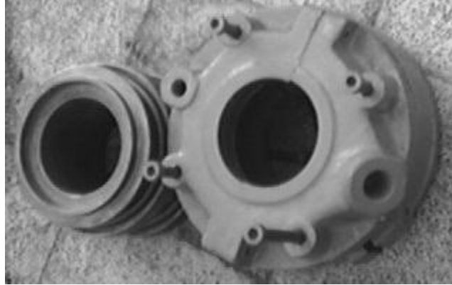
Figura 4.2 Laberinto o sello mecánico de la Turbina Francis
