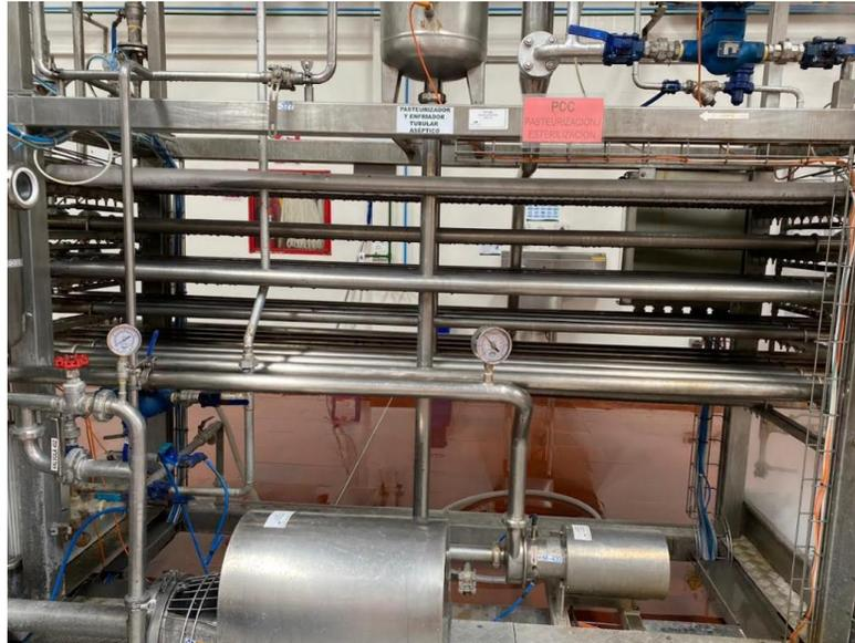
**Figura 4-9.** Proceso de pasteurización de pulpa
