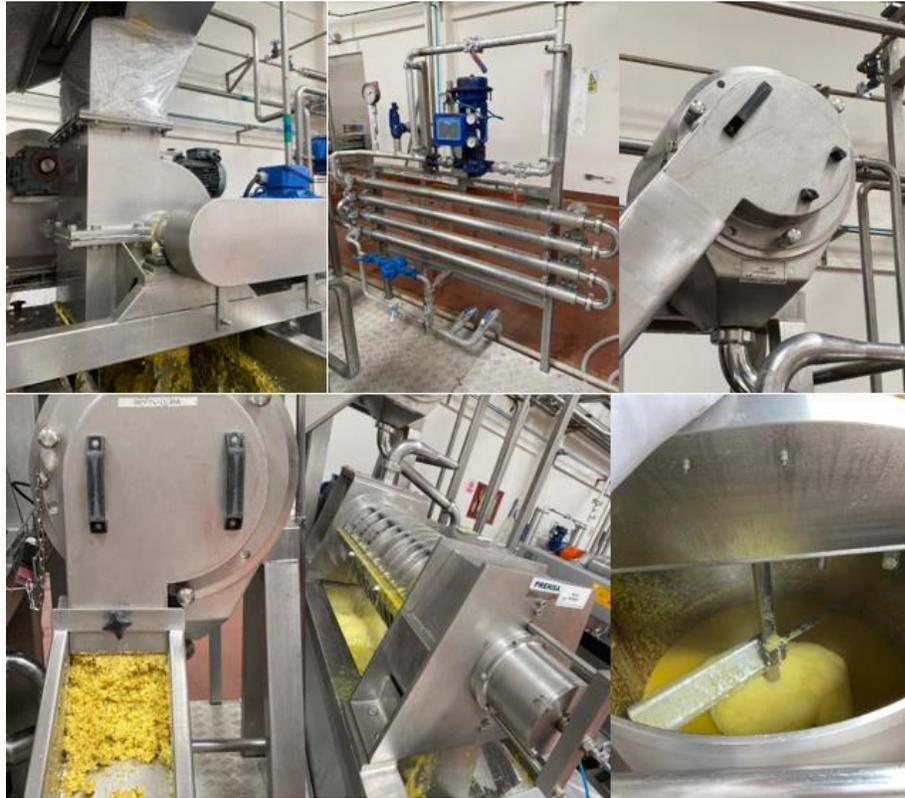
**Figura 4-7.** Proceso de extracción de pulpa
