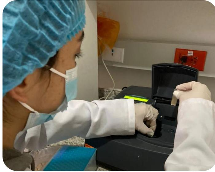
Colocación de cubetas en espectrofotómetro para medir absorbancia
