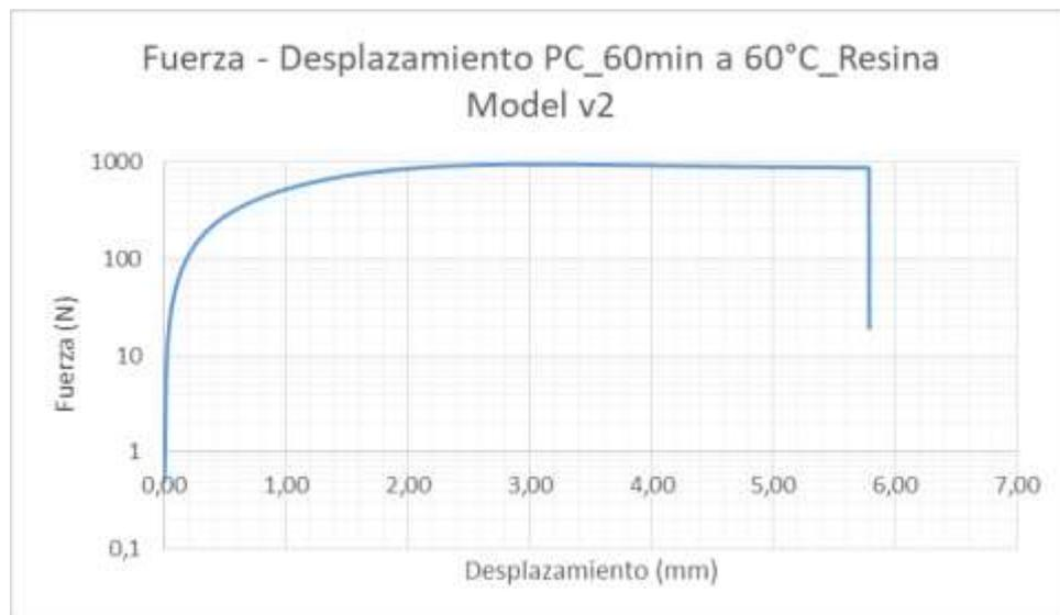
**Figura 63.** Gráfico Fuerza – Desplazamiento probeta Model V2 post - curada a 60 °C durante 60 minutos.
