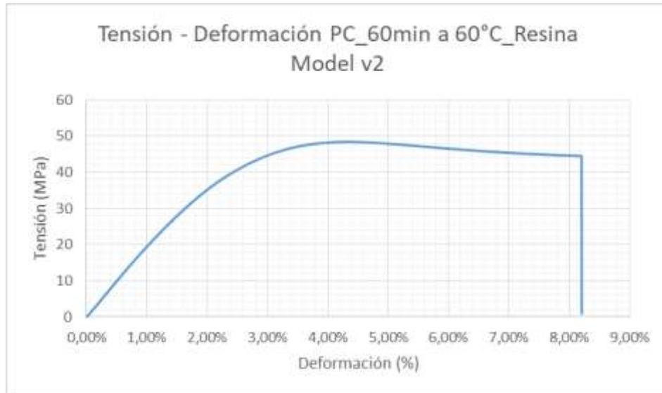
**Figura 61.** Gráfico Tensión – Deformación probeta Model V2 post – curada a 60°C durante 60 minutos.
