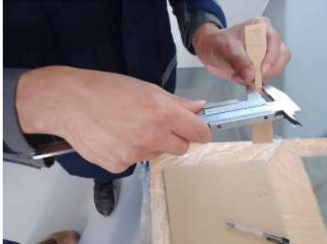
**Figura 27.** Medición del espesor de la probeta
