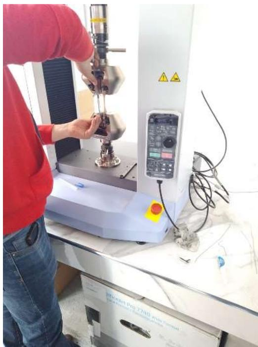
**Figura 29.** Medición de la longitud calibrada de la probeta.
