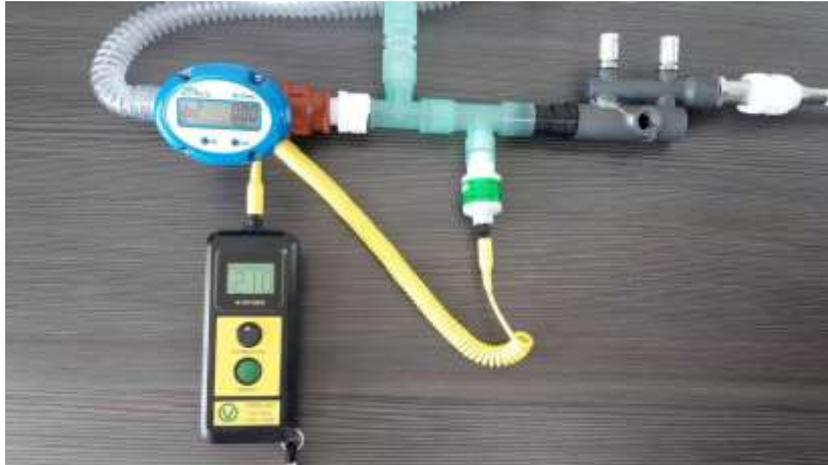
**Figura 75.** Posición inicial de las válvulas y ensamble del circuito de prueba.
