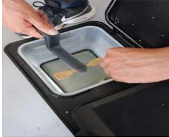
**Figura 21.** Etapa de curado de las probetas.
