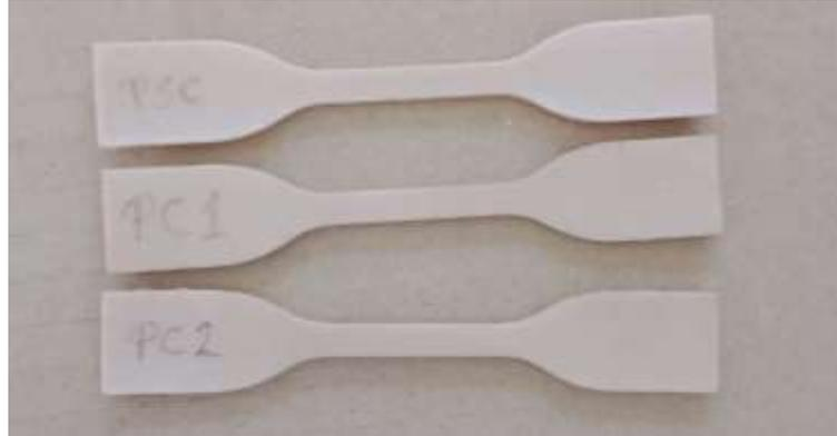
**Figura 23.** Probetas para el ensayo de tracción.
