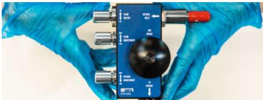
**Figura 8.** Dispositivo UCL Ventura CPAP [28].
