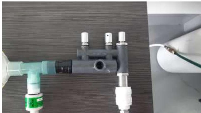
**Figura 74.** Posición inicial de válvulas de control del dispositivo original.
