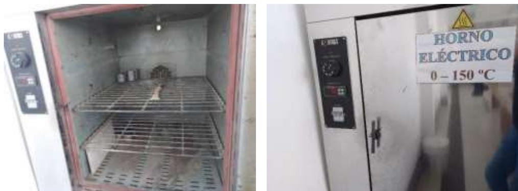
**Figura 22.** Post curado de probetas.
