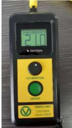
**Figura 73.** Ajuste del medidor de oxígeno en 21% existente en el ambiente.
