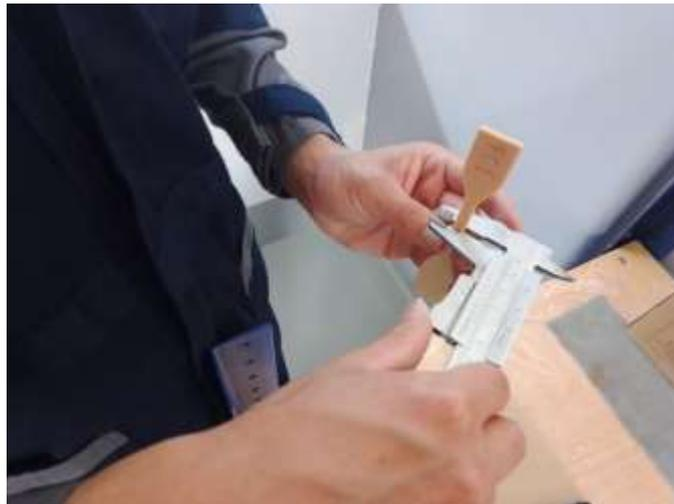
**Figura 28.** Medición del ancho de la probeta
