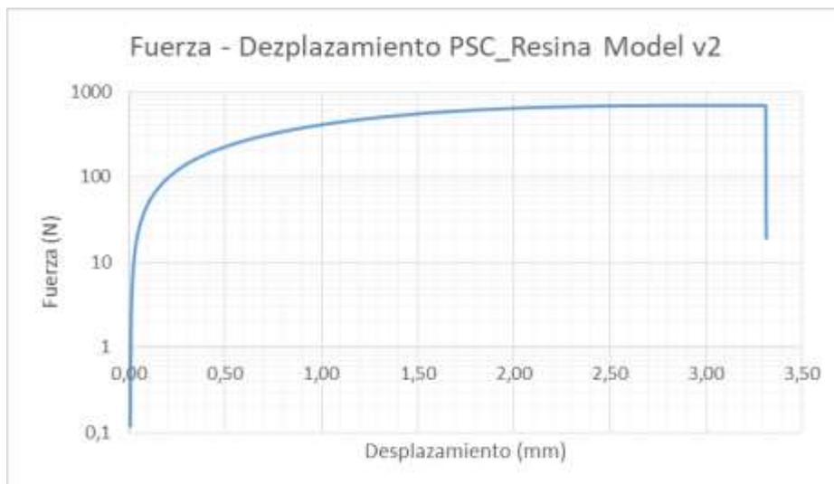
**Figura 55.** Gráfico Fuerza – Desplazamiento probeta Model V2 solo curada.
