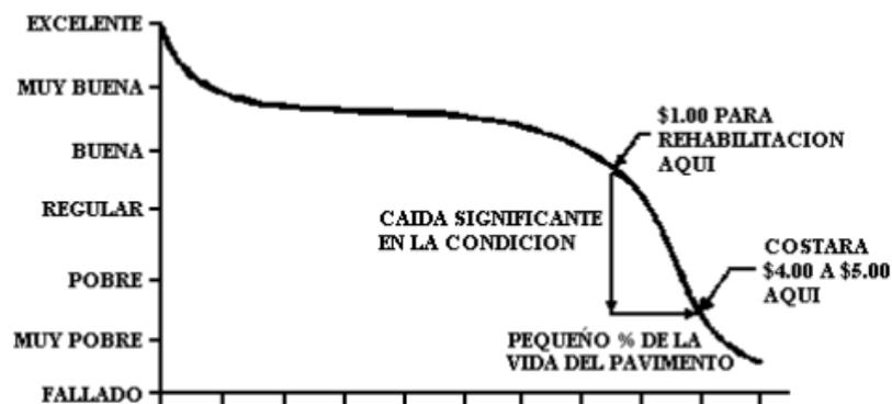
**Gráfica 3** Ilustración Conceptual del Ciclo de Vida de la Condición del Pavimento
