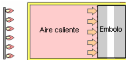
Figura 8. Calentamiento de aire dentro del cilindro [9].
