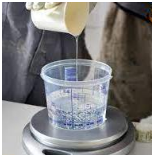
Figura 18: Preparación de la resina epóxica
