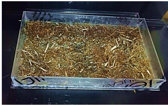
Figura 19: Distribución de la matriz y el refuerzo en el molde
