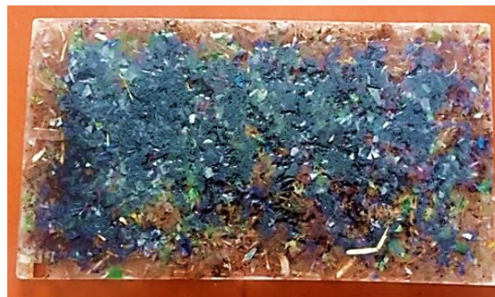
Figura 20: Desmoldar el material compuesto
