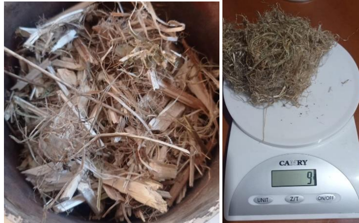
Figura 15: Preparación de la fibra
