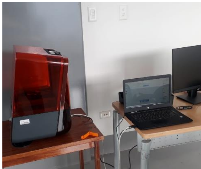
Figura 43. Impresión de las partes del microaspersor original en resina Tough 2000
