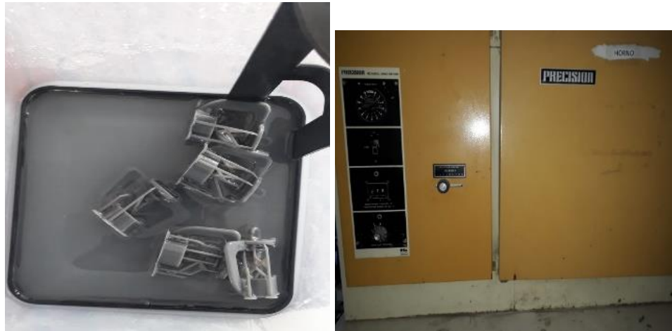
Figura 44. Limpieza y post curado de las piezas con resina Tough 2000
