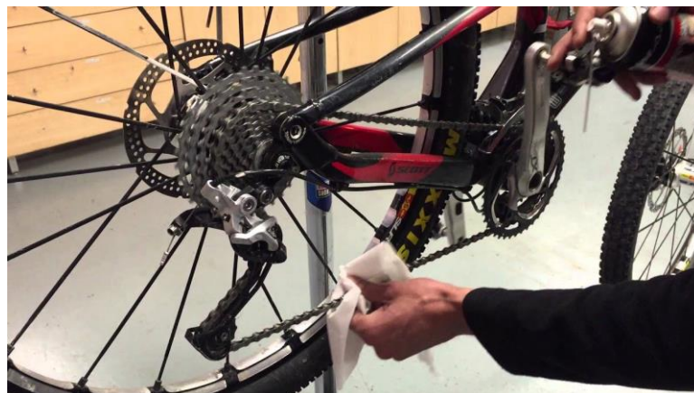
Figura 21. Retiro de exceso con un trapo limpio
