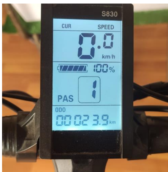
Figura 15. Display del sistema eléctrico
