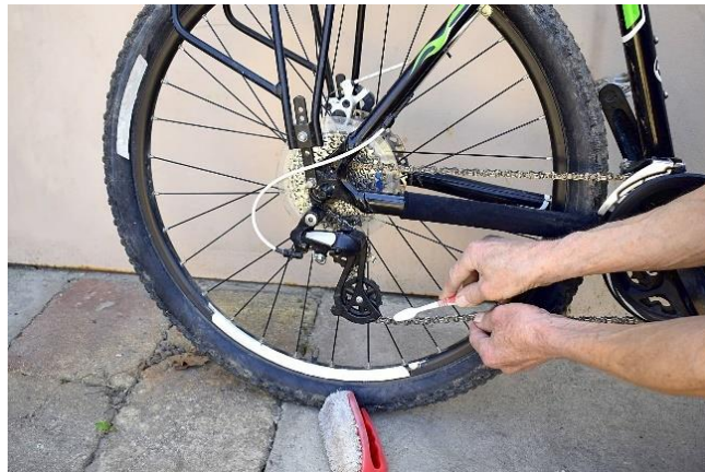
Figura 20. Limpieza de cadenas con cepillo
