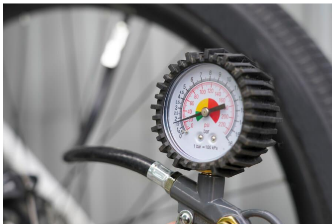
Figura 23. Medición de nivel de presión de neumáticos
