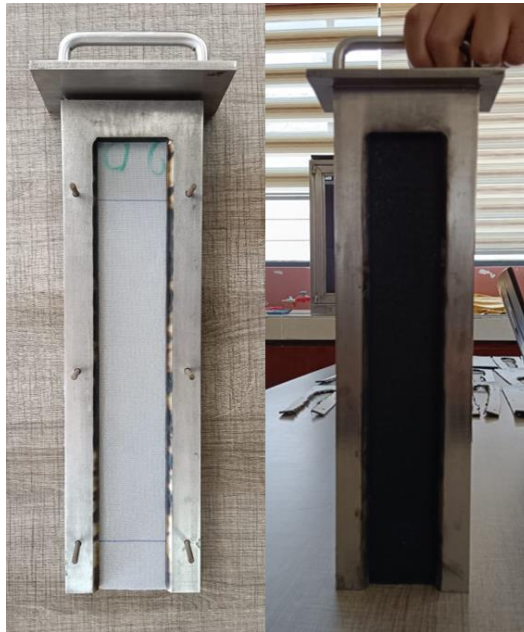
Figura 8. Ubicación de la muestra en el portamuestra.
