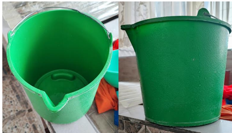
Figura 30: Balde plástico de 11.25 L utilizado para la medición de caudal de entrada a la PTAP “El Mirador”.
