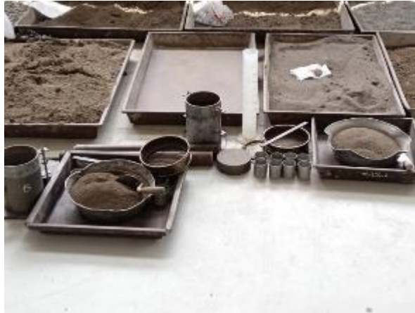
Gráfico 4. Materiales para ensayo de Proctor Modificado en laboratorio de suelos de la Universidad Técnica de Ambato.
