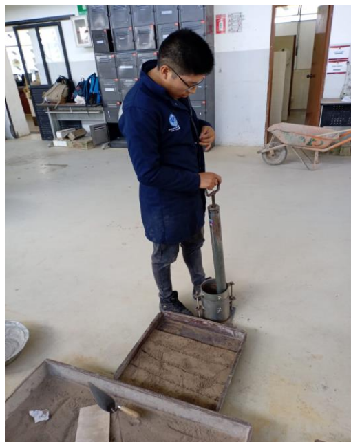
Fotografía 7. Ejecución del ensayo Proctor tipo B
