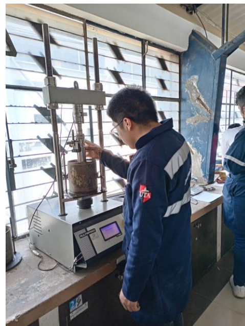
Fotografía 8. Ejecucion del ensayo CBR
