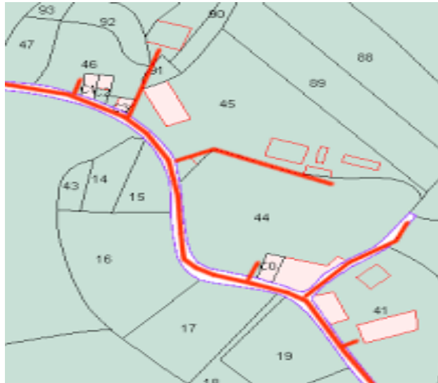
Figura 10: Red de distribución abierta Fuente: Proyecto de Mejora de la Red de Abastecimiento.
