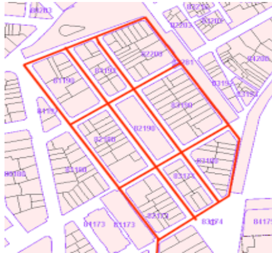
Figura 11: Red de distribución cerrada Fuente: Proyecto de Mejora de la Red de Abastecimiento.
