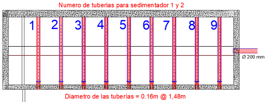
Figura 99: Detalle del número de tuberías para cada sedimentador.
