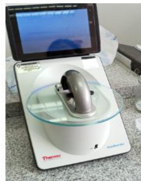
Figura 8. Medición de absorbancias del yogur
