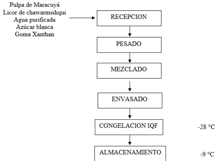
Figura 2. Diagrama de flujo del proceso de elaboración del coctel
