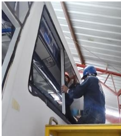
Figura 29. Colocación de vidrios.
