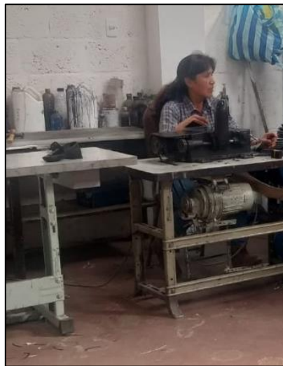
Figura 12. Proceso de desbastado del cuero.
