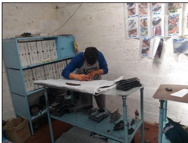
Figura 11. Corte manual del cuero y forro.
