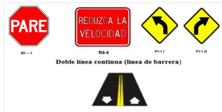
Figura 34 Señalización vertical y horizontal
