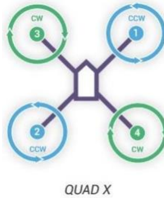
Figura 29. Configuración de motores en cuadricóptero, forma X [27]
