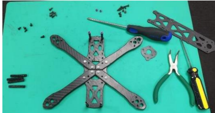
Figura 73. Montaje de Frame
