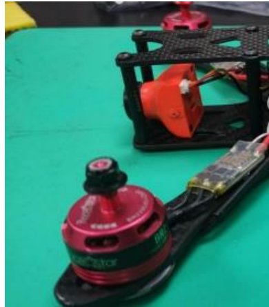
Figura 80. Conexión y montaje de cámara FPV
