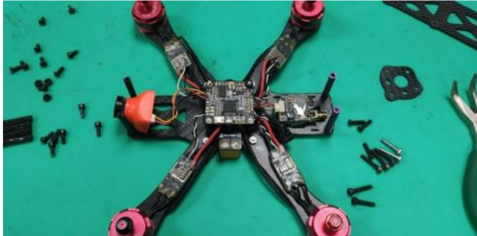
Figura 76. Conexión de la placa controladora en el frame
