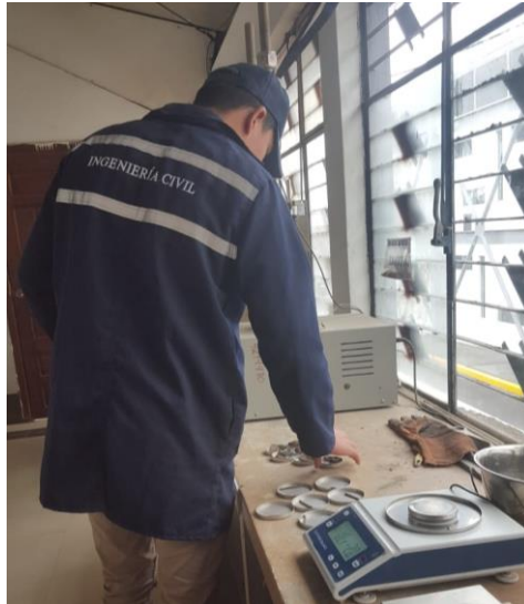
Figura N°19. Toma de pesos para límite plástico
