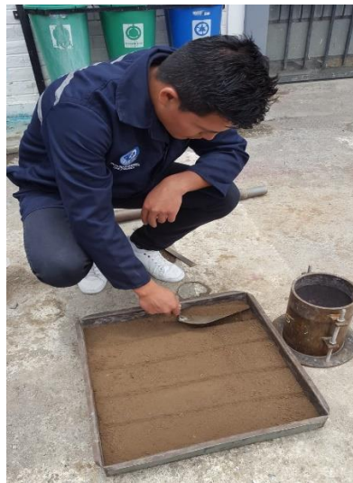
Figura N°21. Colocación de muestra de suelo en molde de compactación
