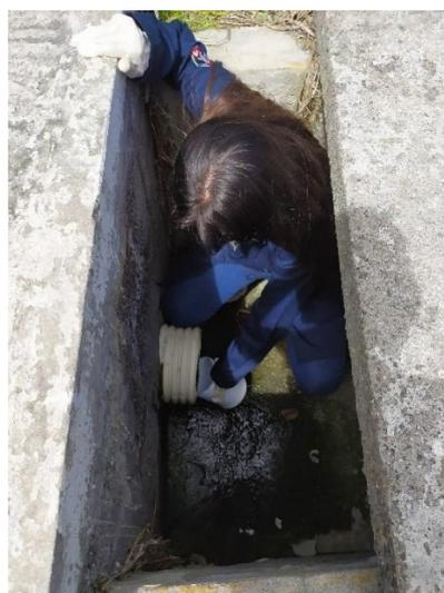
*Ilustración 11: Medición del volumen del caudal de salida de la PTAR*
