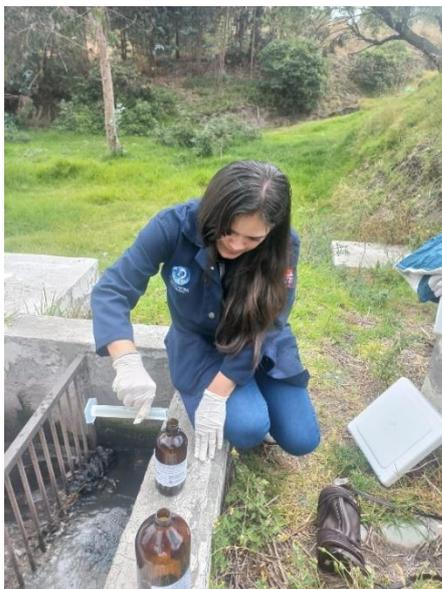
Ilustración 14: Recolección de muestras compuestas de agua residual del afluente de la PTAR
