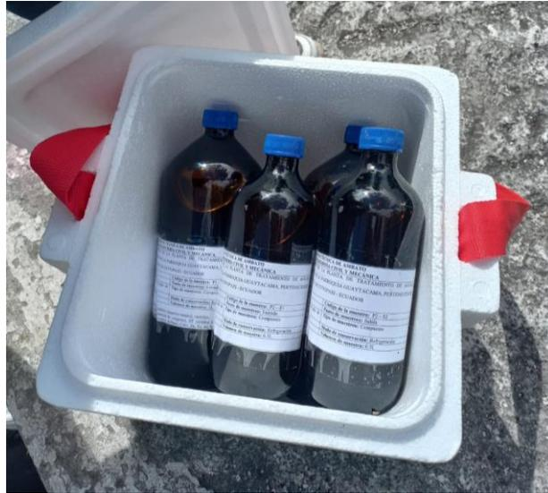
*Ilustración 16: Conservación y transporte de las muestras compuestas obtenidas de la PTAR*
