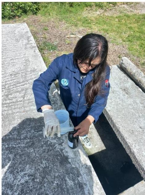
Ilustración 15: Recolección de muestras compuestas de agua residual del efluente de la PTAR
