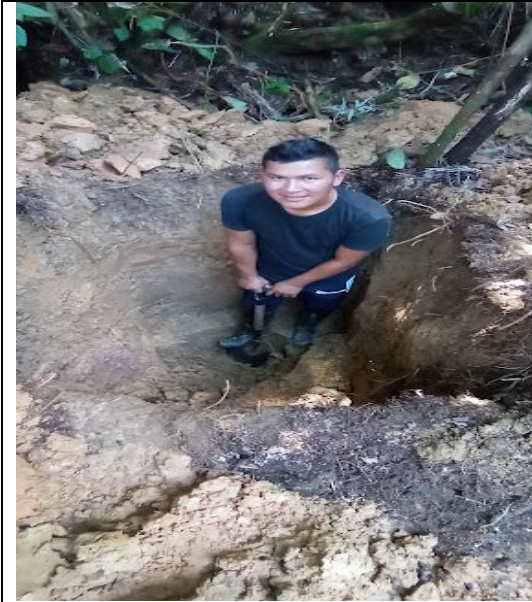
Calicatas de (1x1x1) m
