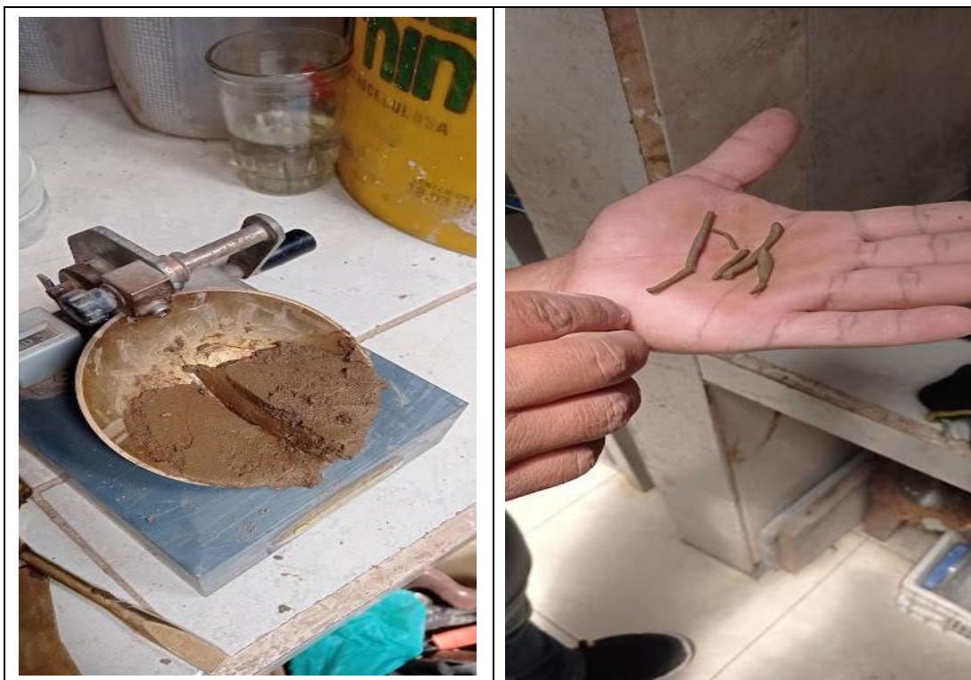
Ensayo de los límites de Atterberg
