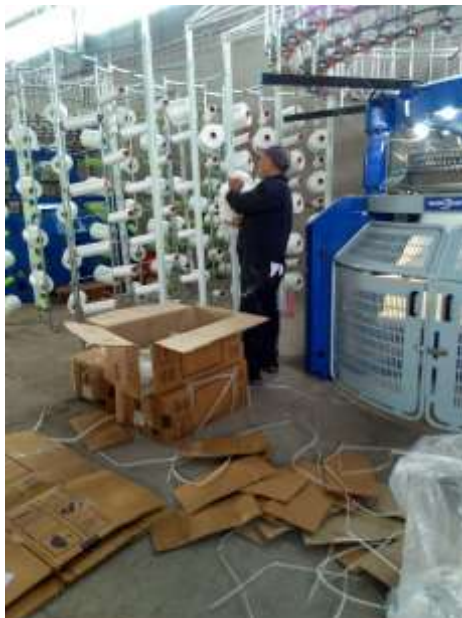
a) Falta de limpieza en el área de tejido.
