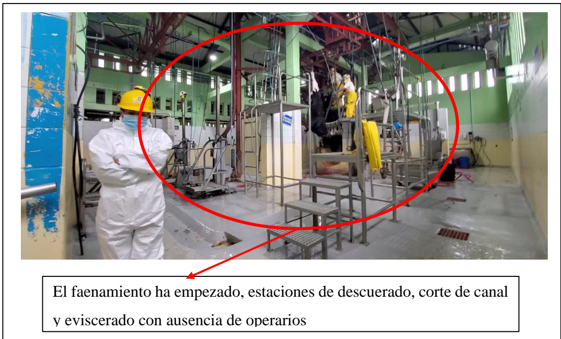
Figura 22. Esperas, operarios no están en sus estaciones al inicio.
