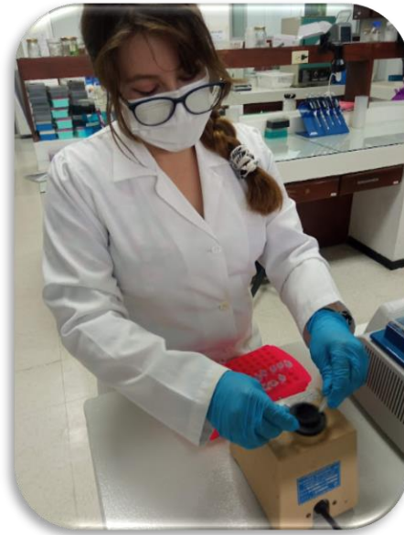
Foto 52. Uso del vortex para permitir la unión de las perlas de zirconia con el algodón del hisopo
