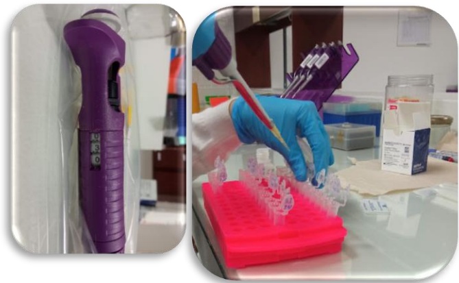
Foto 55. El sobrenadante obtenido, se transfirió a los tubos eppendorf de 0.5 ml, con la ayuda de una micropipeta
