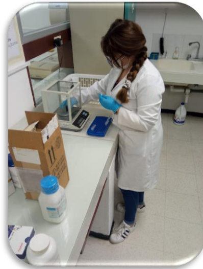
Foto 47. Peso de los tubos eppendorf para su posterior adición de 0.02 a 0.03 g de perlas de zirconia
