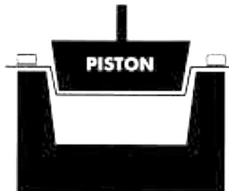
Figura 9. Termoformado a presión con ayuda de pistón molde hembra [48].
