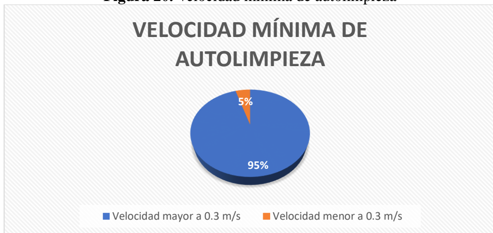
Figura 20. Velocidad mínima de autolimpieza
