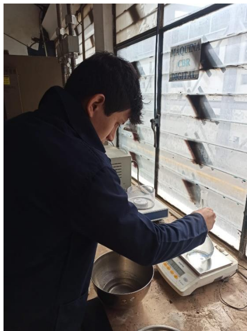
Figura 71: Toma de pesos del picnómetro.
