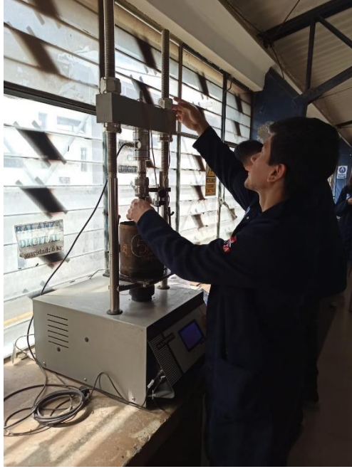
Figura 82: Ensayo de los moldes en la máquina CBR.
