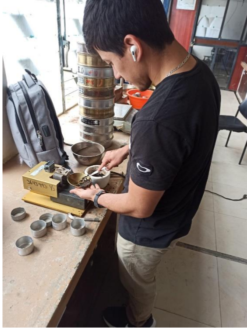
Figura 76: Realización del ensayo Copa Casagrande. Autor: Bryan Joaquín Mayorga Viteri
