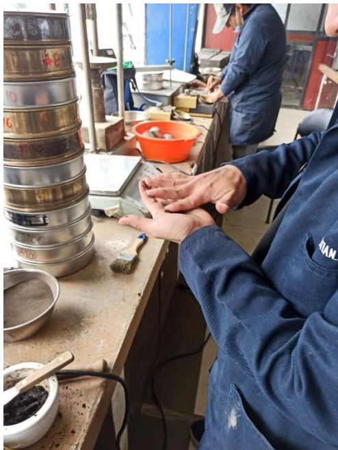
Figura 77: Preparación de los rollitos de muestra de suelo. Autor: Bryan Joaquín Mayorga Viteri
