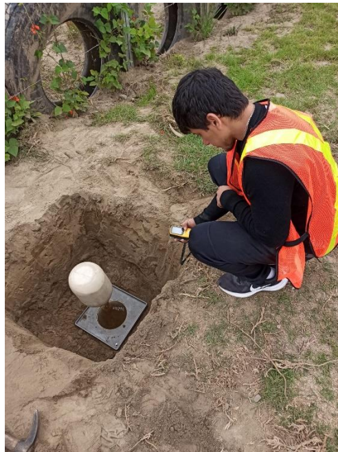
Figura 67: Determinación de la densidad de campo.
