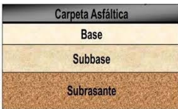
Figura 13: Estructura del Pavimento Flexible
