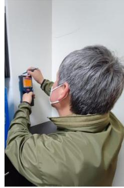
Comprobación del refuerzo longitudinal en columna G10
