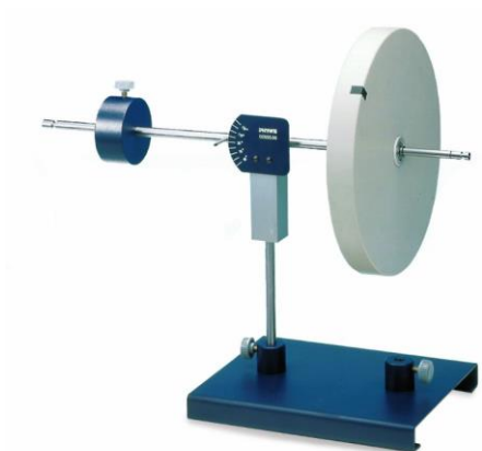
Figura 16. Giroscopio de tres ejes [21].
