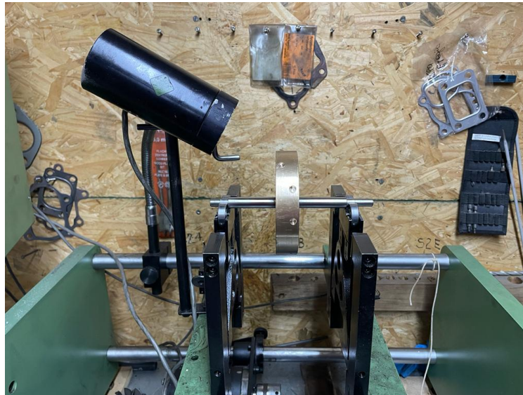
Figura 50. Eje y rotor montados en la máquina balanceadora.
