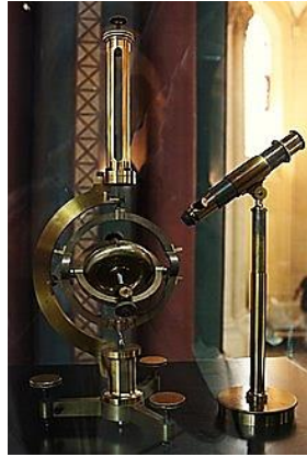
Figura 2. Giroscopio con un montaje en anillos de cardán [2].
