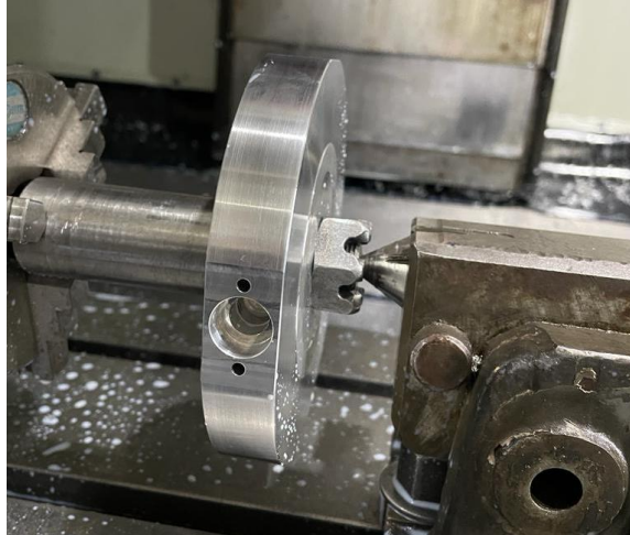
Figura 48. Proceso de mecanizado del anillo.
