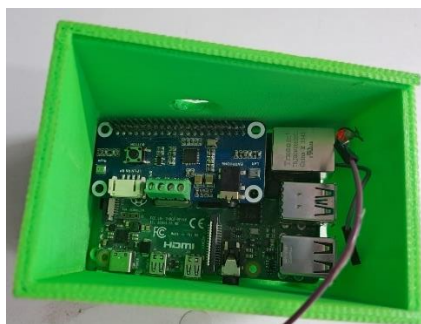
Figura 52 Montaje del microcontrolador principal Raspberry pi en case Elaborado por: Investigador
