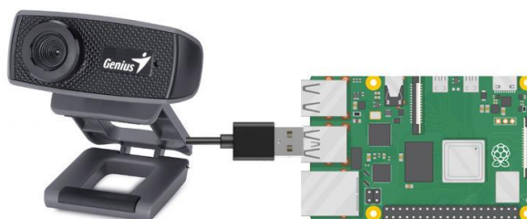
Figura 27 Diagrama de conexión Facecam 1000x con Raspberry pi 4. Elaborado por: Investigador
