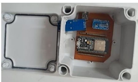
Figura 53 Montaje del circuito de ESP 32 en case de protección Elaborado por: Investigador
