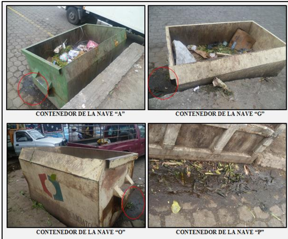
FIGURA 4.7: Presencia de líquidos lixiviados en las periferias de los contenedores. Fuente: Autor.
