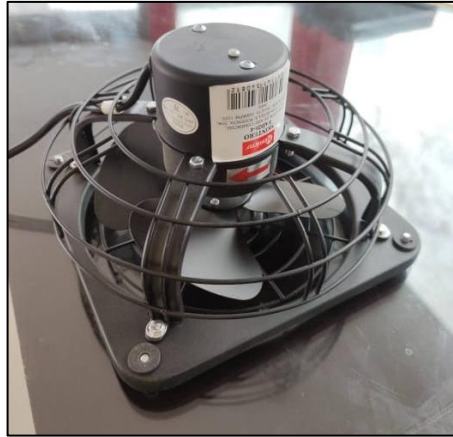
Figura 68: Extractor de gases contaminantes
