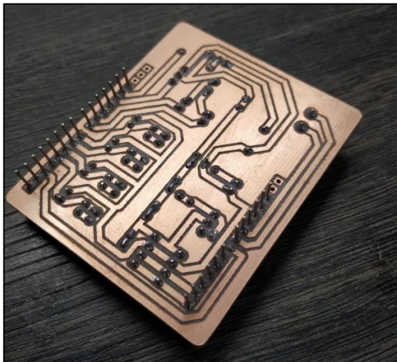
Figura 91: Parte posterior de la PCB con componentes soldados.
