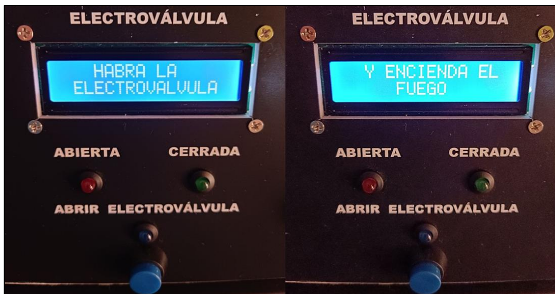
Figura 99: Mensajes iniciales del estado de la electroválvula.
