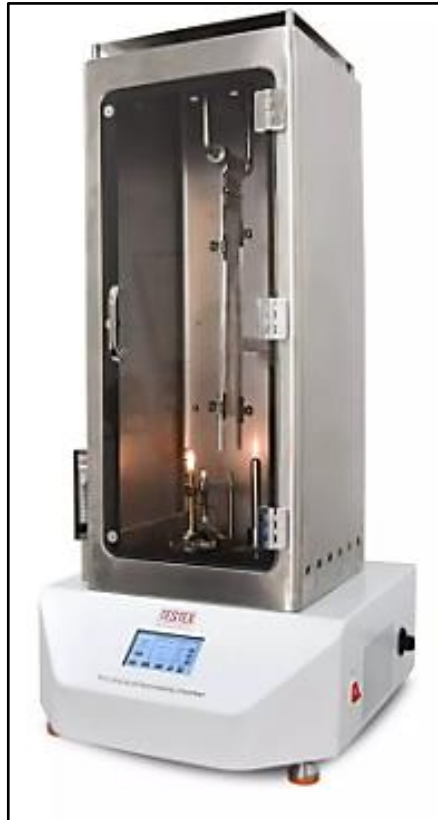
Figura 7: Cámara de inflamabilidad vertical [14].
