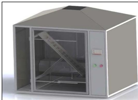
Figura 9: Cámara de inflamabilidad de juguetes [12].
