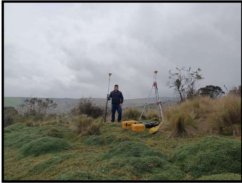
Figura 31. Levantamiento topográfico con RTK
